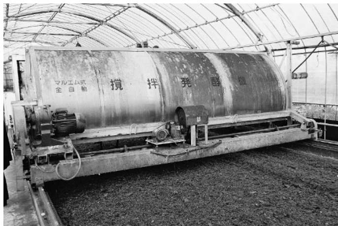
写真3 レーン式自走醗酵機（許可を得て筆者が撮影）
