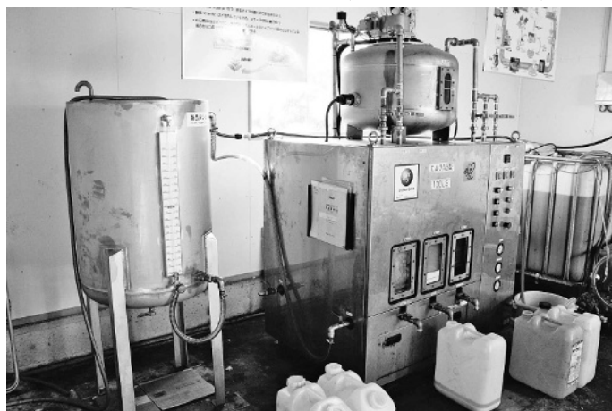
写真6 廃食油燃料化プラント（許可を得て筆者が撮影）
