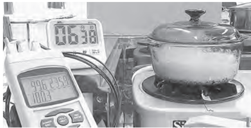
図3 ガラス鍋による炊飯時の温度変化測定
