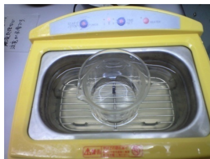
6. バイアスストレス印加後、アセトン・エタノールを用いてESR サンプルを洗浄する.
