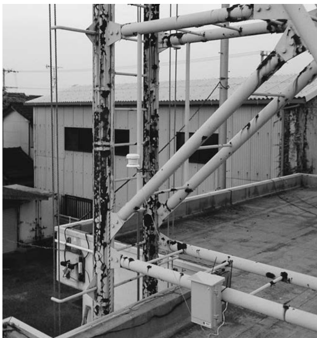
写真5 高松市消防団仏生山分団屯所の鉄塔支柱に設置した温度計とデータ収録装置
