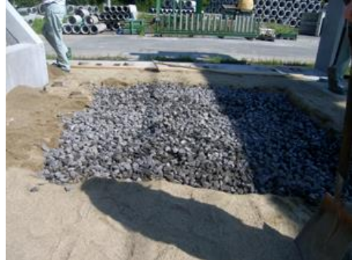
滑動試験用マウンド（砂地盤：左，砂利地盤：右）
