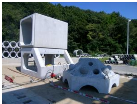
滑動試験用マウンド（砂地盤：左，砂利地盤：右）
