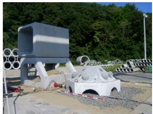
滑動試験用マウンド（砂地盤：左，砂利地盤：右）
