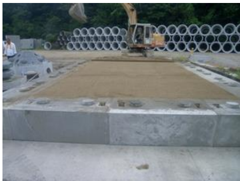
滑動試験用マウンド（砂地盤：左，砂利地盤：右）
