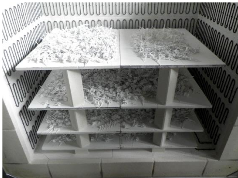
電気炉（焼成後）
