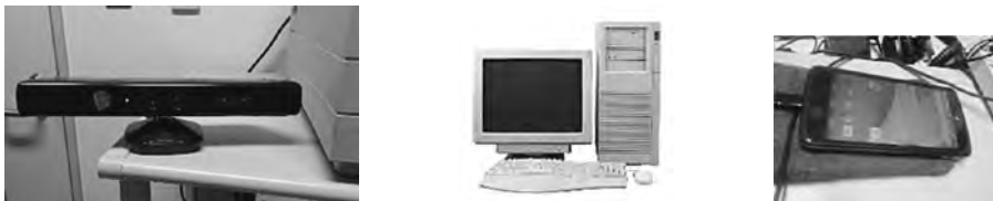
Kinect (音声認識) ⇔ [USB] ⇔ コンピュータ ⇔ [USB] ⇔ スマートフォン
