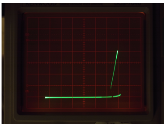
図 3.15: thyristor mode における V-I 特性
