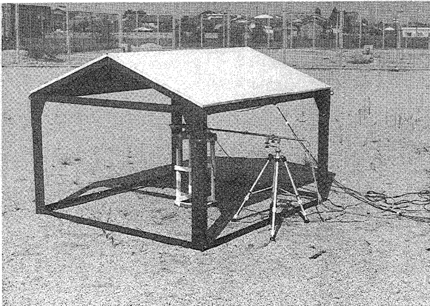
図4-3 切妻屋根式模型畜舎（屋根傾角22度）
