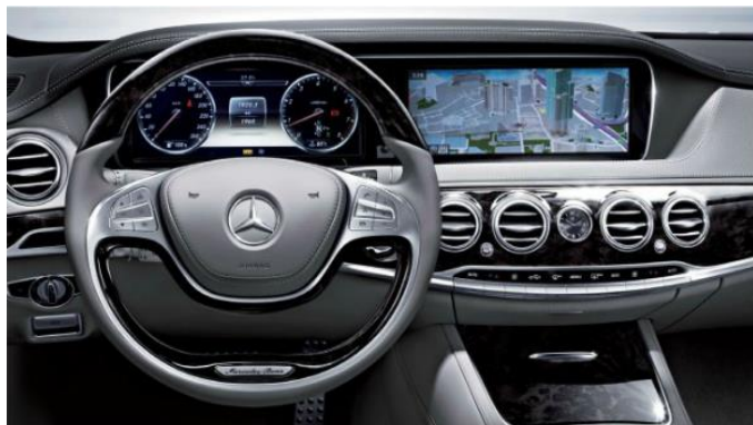
図 1-12 12.3 インチメータディスプレイ (Mercedes-Benz)
