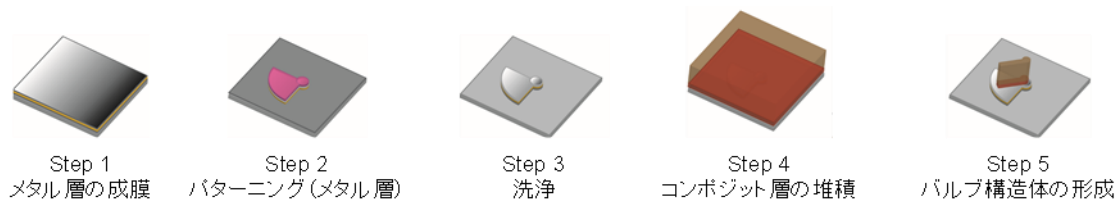
(a) メタル層とバルブ構造体の形成
