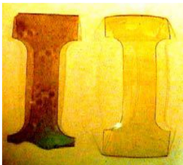
Figure 1-1 Chiamori らによる SU-8/Au コンポジット
