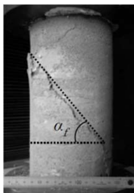
図 6-11 一軸圧縮試験用試験体の破壊状況
