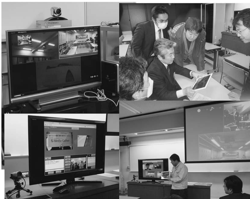
図2 A. 左上Polycom ® HDX 8000TVモニター画面，3地点で接続している場合。それぞれの画面の表示はコントローラーで調節できる。B. 左下FLCSモニター画面に映った文字も十分に判読可能。C. 右上カメラとして使用しているiPad。D. 右下 会議室で視聴した場合の提示例。
