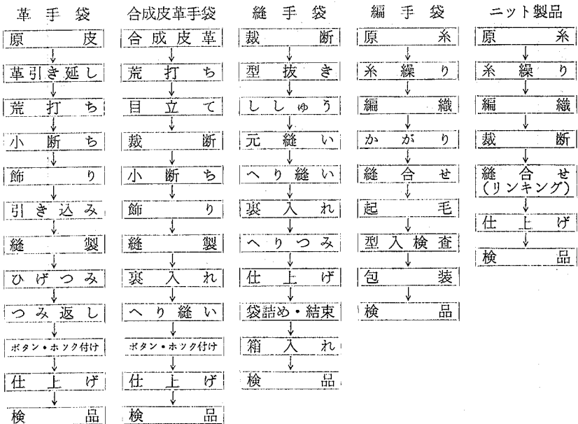
図表3 手袋の製造工程
