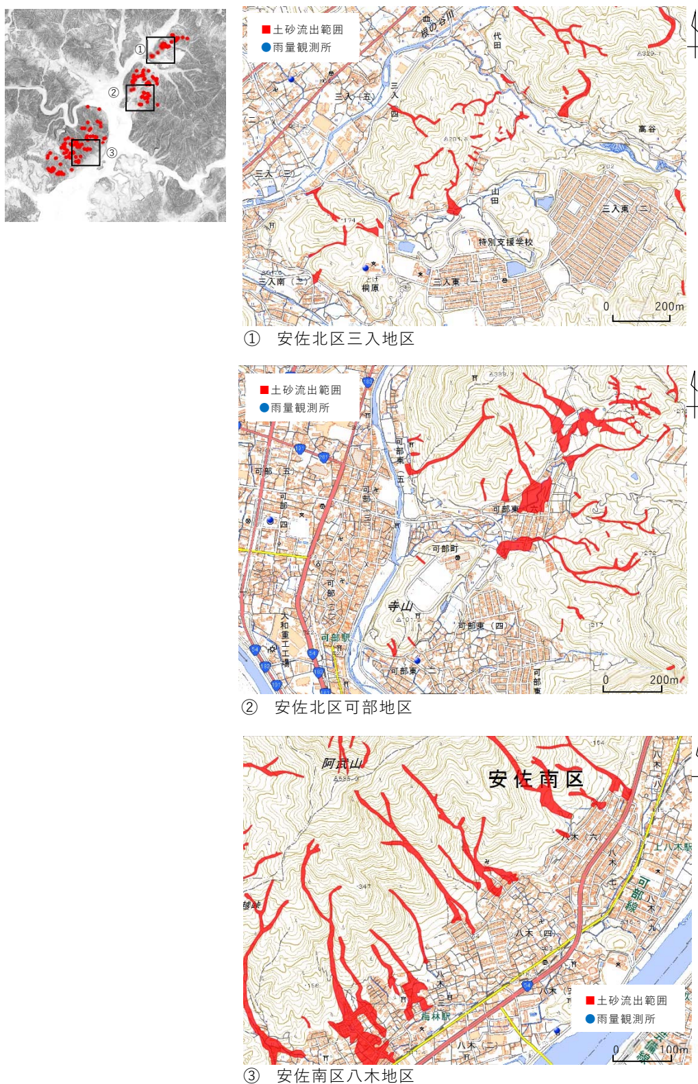
図-6.1.7 広島市安佐北区・安佐南区での土石流発生溪流の分布例
