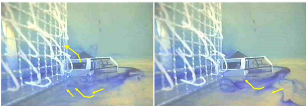
写真-2.1.6 染料法による実験構造物模型を置いた場合の模型後方の流れの状況 (流れの後方から水中カメラで撮影したビデオ映像の静止画)
