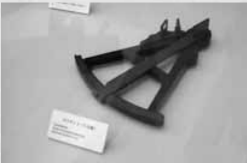
図3 オクタント(八分儀)。二つの物体(例えば恒星と恒星など)の間の角度を測定するための装置です。中村他(2000年) (3) によると、バーニア(副尺)が日本で初めて理解されて使われたということです。
