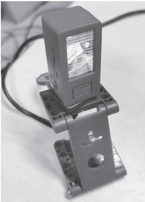
図1 AIカメラ (M5StickV)
