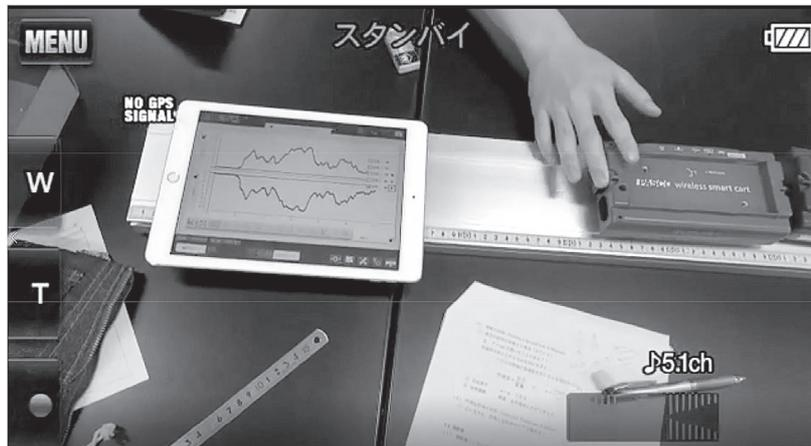
図3 圧力センサー付きの力学台車（パスコ製スマートカート）を2台使って押し合いをさせ、作用反作用の法則をその場で実験して iPad 上で表示させている様子。これを Zoom で配信。
